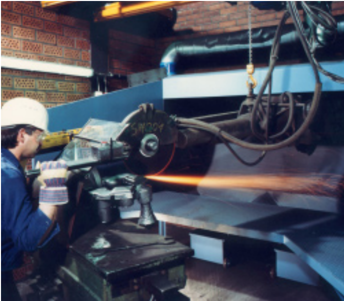
Bild 8: Beispiel für die Ausbildung von Wirbelsenken Wirbelhaube zur Erfassung von Schleifstaub an einer Pendelschleifmaschine
