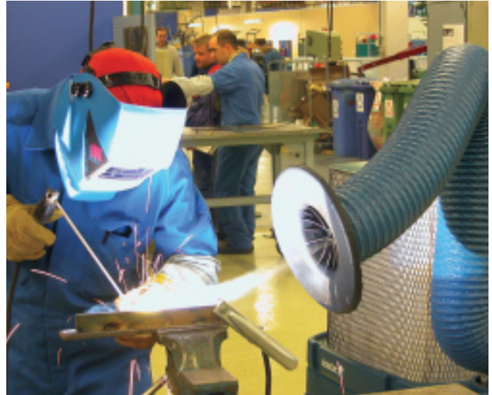
Bild 1: Beispiel für arbeitsbedingte Flexibilität Schweißrauchabsaugung mittels Flanschdüse
