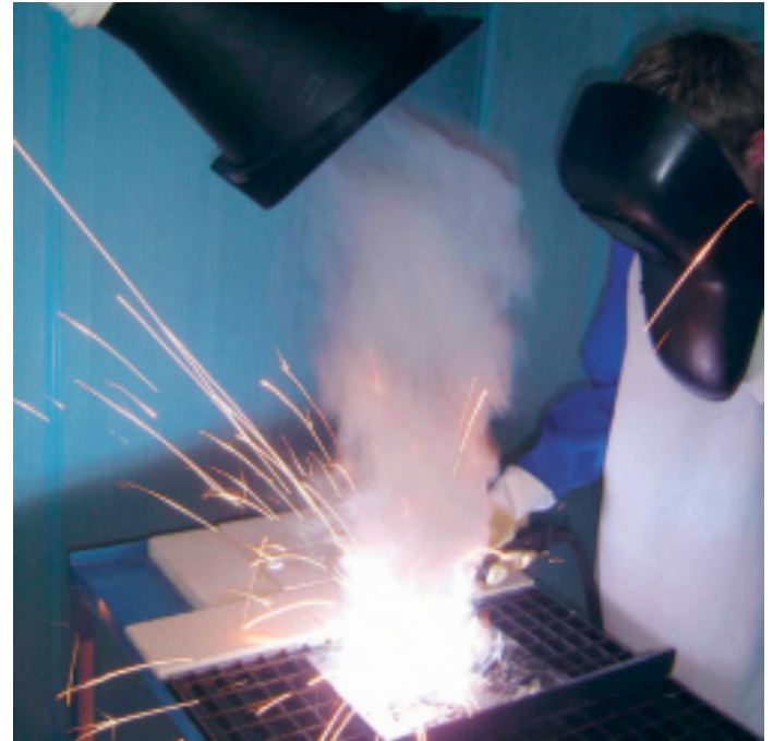
Bild 5: Beispiel für Thermikströmungen Schweißen mit höheren Temperaturen und hoher Rauchentwicklung
