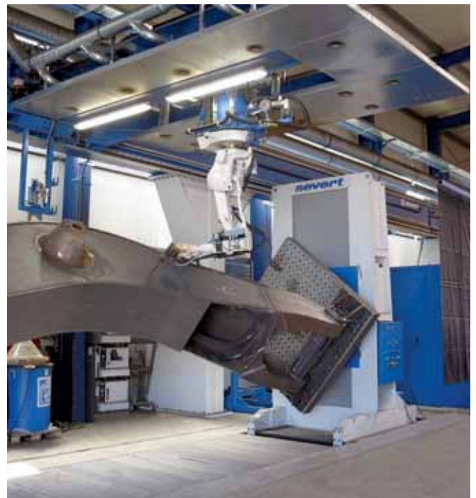
Bild 6: Absaughaube über Schweißroboter
