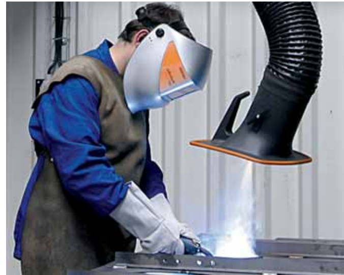
Bild 5: Absaughaube einer Niedrigvakuum- Punktabsaugung
