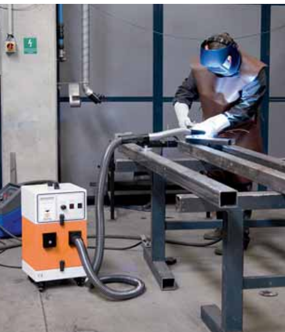
Bild 4: Hochvakuum-Punktabsaugung Quelle: KEMPER GmbH
